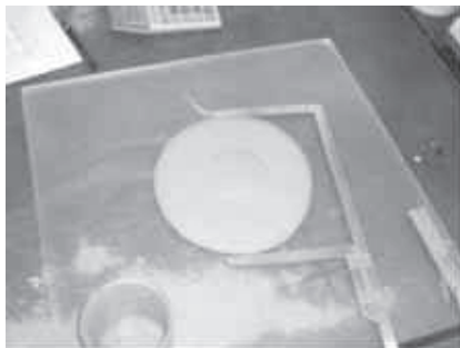
写真1 フロー試験の様子 Photo 1 Overview of flow test
